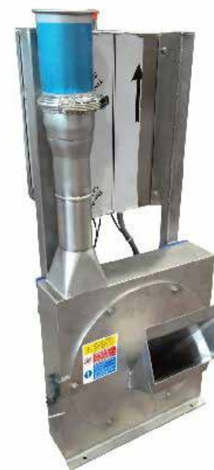
RITORNO DEGLI SCARTI DISPONIBILI IN VERSIONE PNEUMATICO O CON NASTRI TRASPORTATORI Return scraps of pasta available in two versions, pneumatic or with conveyor belts
